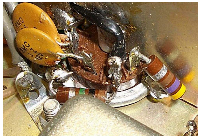
Fig 7. Gallerläckan 1 Mohm flyttades för att komma närmare chassiet. (Minskad antennverkan)
