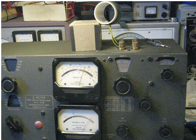
Spolens Q-värde mäts till 180 med 50 pF parallellkapacitans.
