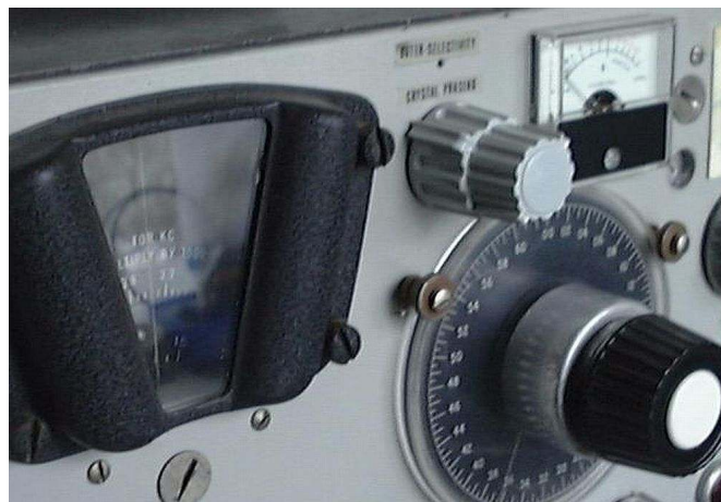
Montering av kristallfilter i BC-312M, utförd av SM6ECR (SK).
