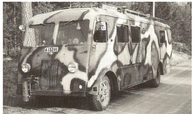
"Per-Albin-bussen" Mobil/transportabel mottagarstation för regeringens kommunikationer. Bevarad i Malmköping
