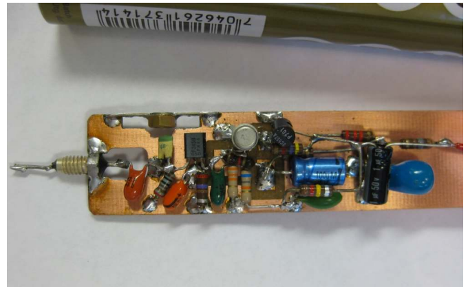
Proben uppbyggd på ett stycke glasfiberlaminat
